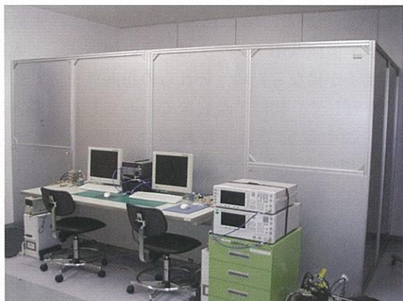
写真1 構築した電波反射箱の外観
