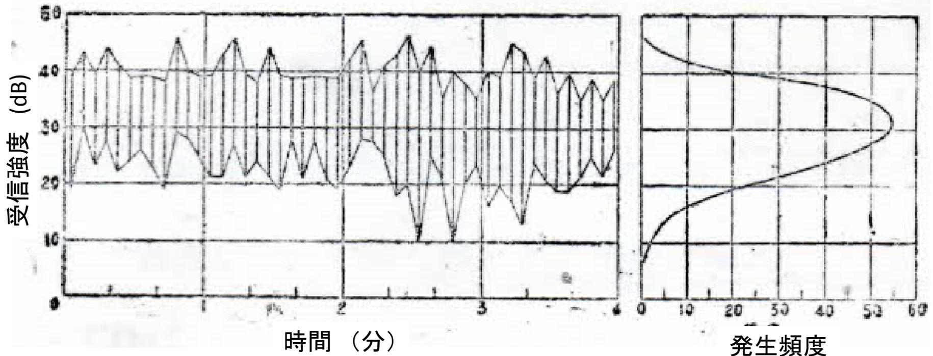
今のように自動記録したデータをパソコンが解析してくれる時代と違って、仲上が働いていた時代（1930～1940年代）には、測定データもブラウン管を見て写真を撮ったり自記記録計の紙データであったりで、解析もすべて手作業である。短波のフェージングの周期は数秒程度以下であるので、観測単位時間を3～5秒とし、その間における電界強度の変動の範囲（最大値と最小値）をもってその間の電界強度の変動を代表させ、これの数分間の連続記録（左）から頻度分布（右）を得ていたようである。
