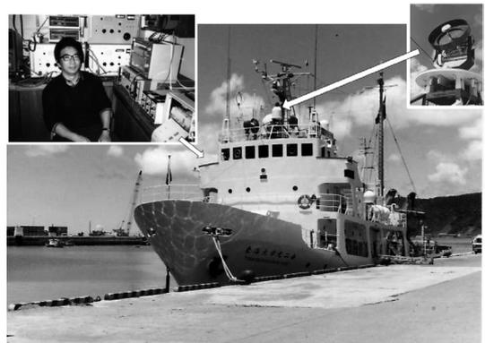
図8 洋上実験に備船した東海大学丸二世号 (701トン) (右上: フェージング軽減機能を組み込んだショートパッチファイアアンテナ; 左上: 船内の測定機器と塩川博士)
