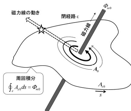
図5 誘導起電力（導線が磁力線を切るとき（☆）に生まれる）の説明図（無数に敷き詰められた磁力線の本一本に着目）
