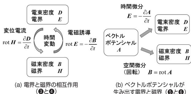
図4 電磁波伝搬に見る電界・磁界・ベクトルポテンシャルの関係
