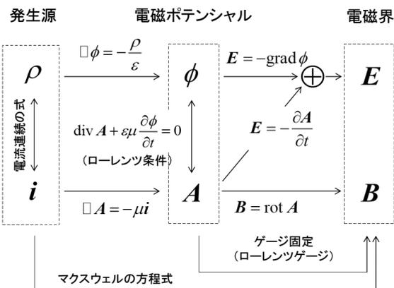
図2 電磁界の発生源 (ρ, i)、電磁ポテンシャル (φ, A)、電磁界 (E, B) の関係
