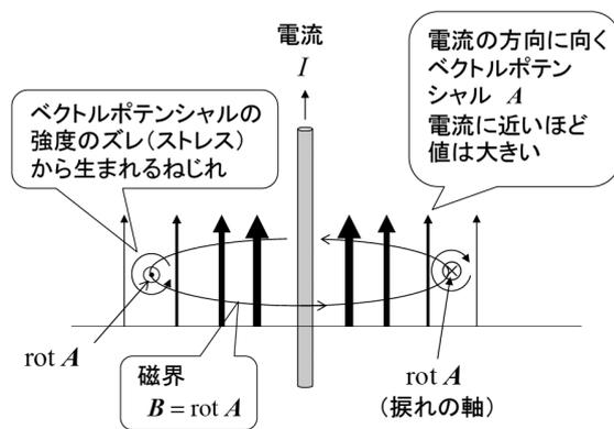
図1 電流に寄り添うように生まれるベクトルポテンシャル、その強度のストレスが磁界を生む
