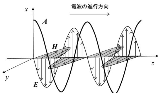
図3 平面波伝搬の描像（ベクトルポテンシャルの時間微分が電界を、空間微分が磁界を作る）
